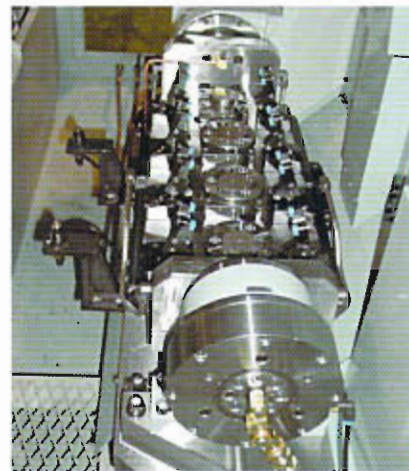
Со смонтированным люльечно-зажимным приспособлением
